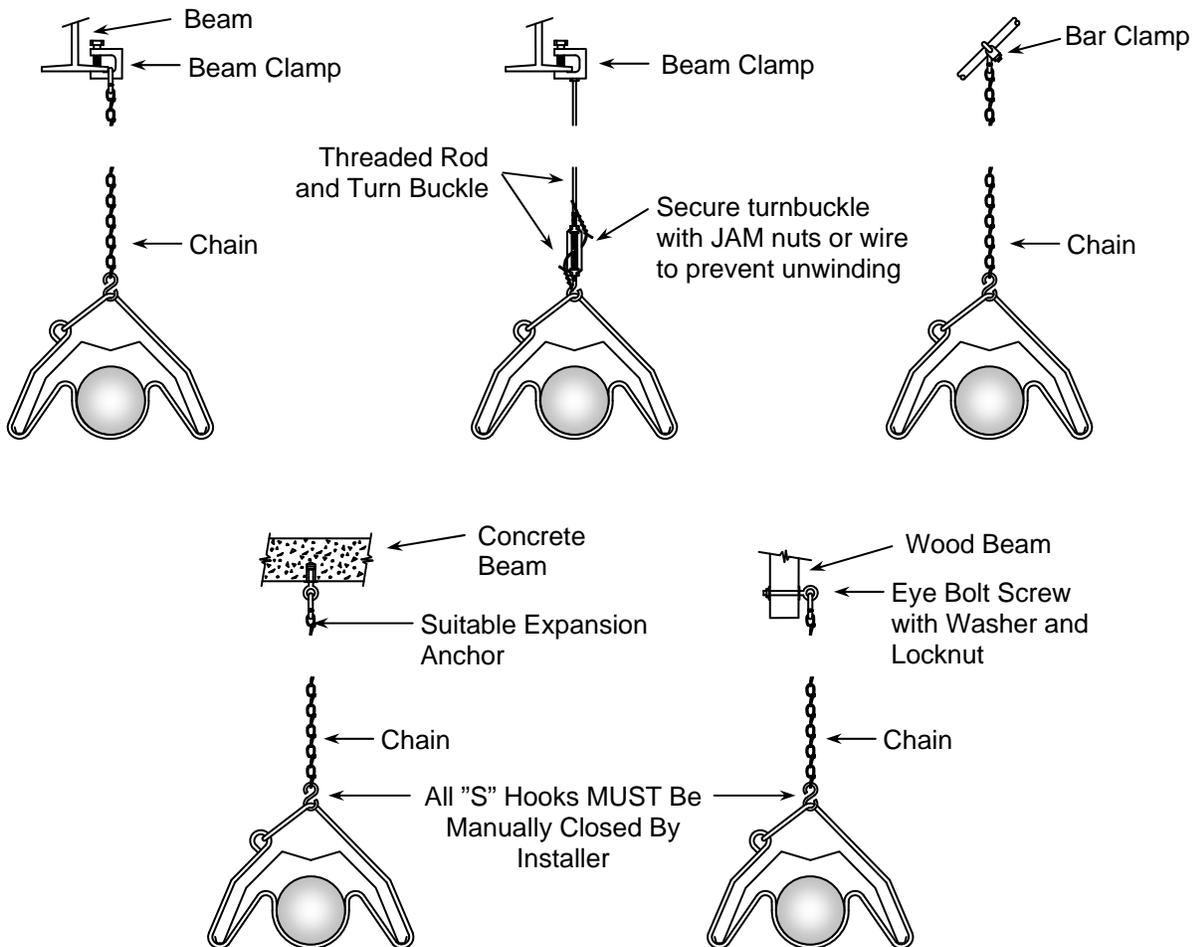
**SEISMIC RESTRAINT SUSPENSION METHODS**
